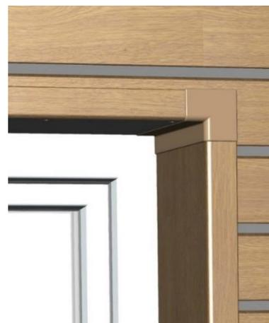
Zur Herstellung der oberen Ecken können Winkelverbinder eingesetzt werden.
