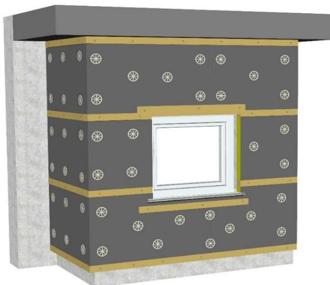
Der Dämmstoff muss für den Verwendungszweck als Fassaden-dämmstoff für vorgehängte, hinterlüftete Fassaden geeignet sein. Die Verarbeitungsvorschriften der Hersteller sind zu berücksichtigen, ggf. ist eine mechanische Befestigung mit Dämmstoffhaltern vorzusehen.
